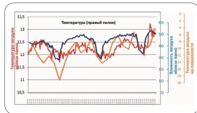
Рис. 2. Мониторинг тепловлажностного режима станции в течение 30 часов. Резкие изменения температуры на поверхности отражаются на изменении влажности в сооружении
