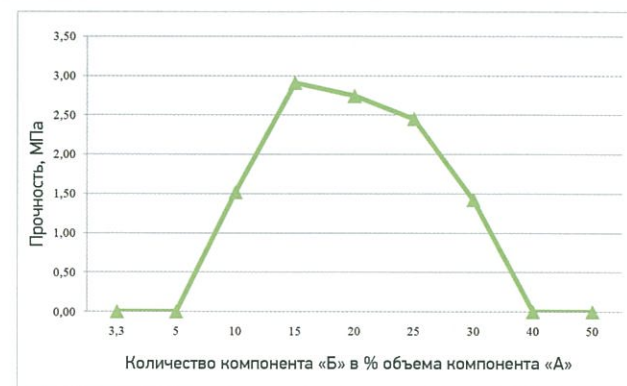
Рис. 4. Прочность образцов тампонажного камня в первые сутки в зависимости от количества компонента «Б»
