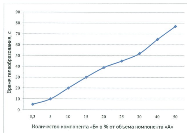
Рис. 2. Зависимость времени гелеобразования от количества компонента «Б»
