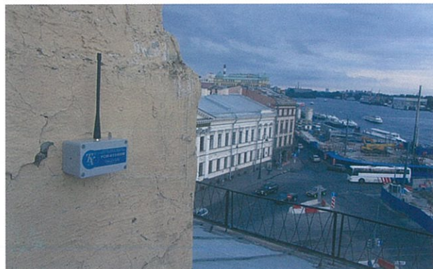
Рис. 2. Вид измерительного модуля со встроенным MEMS-инклинометром
